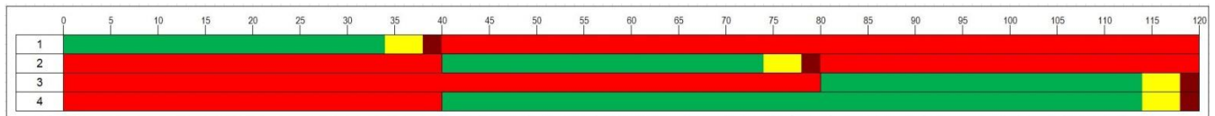
Figura 53: Tempos semaforizados de cada estágio da Interseção nº 4
