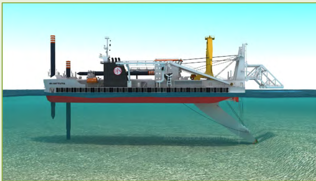
Figura 5.3.2.7-9: Esquema de uma draga de corte e sucção com propulsão.
