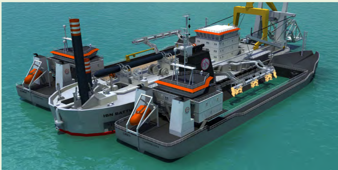
Figura 5.3.2.7-10: Modelo esquemático do processo de enchimento dos batelões.
