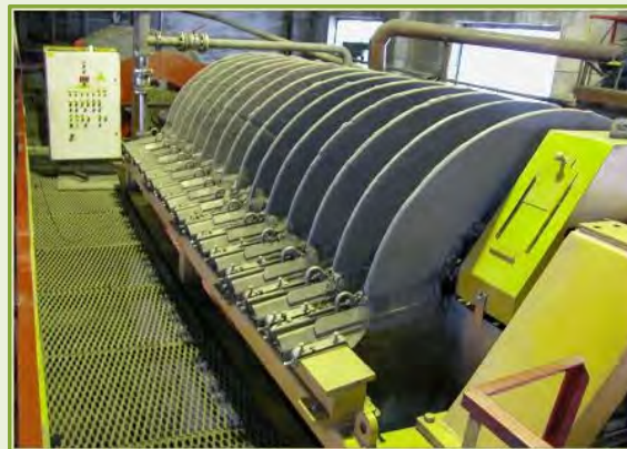
Figura 5.2.2.1-2: Exemplo de Filtros de discos cerâmicos (obtido no site http://www.delkorglobal.com ). Fonte Ausenco.
