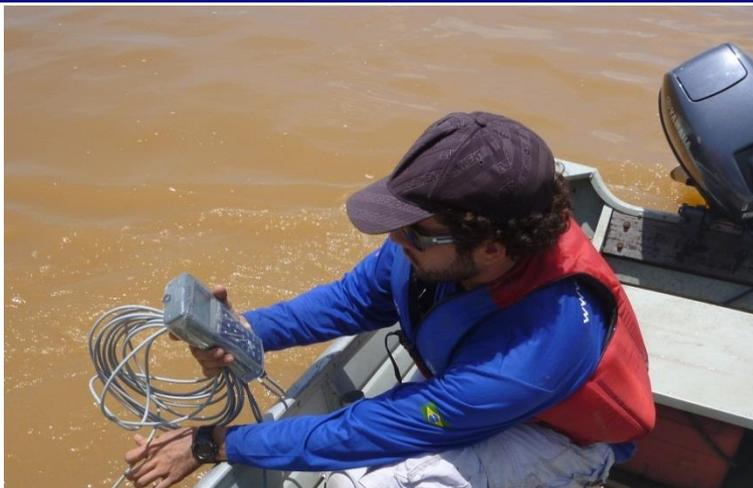
**Figura 6-77:** Aparelho Multiparâmetros (marca Hanna Instruments, modelo HI 9828) utilizado para as análises in loco.
