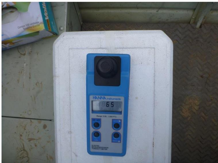
**Figura 6-76:** Turbidímetro (Marca Hanna Instruments, Modelo HI 93703) utilizado para as análises in loco.
