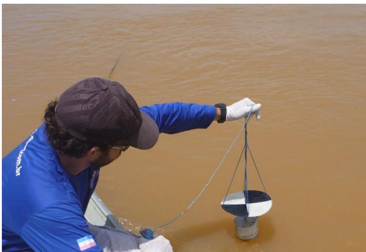
**Figura 6-78:** Utilização do Disco de Secchi.
