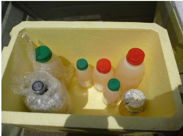
**Figura 6-74:** Acondicionamento das amostras de água.
