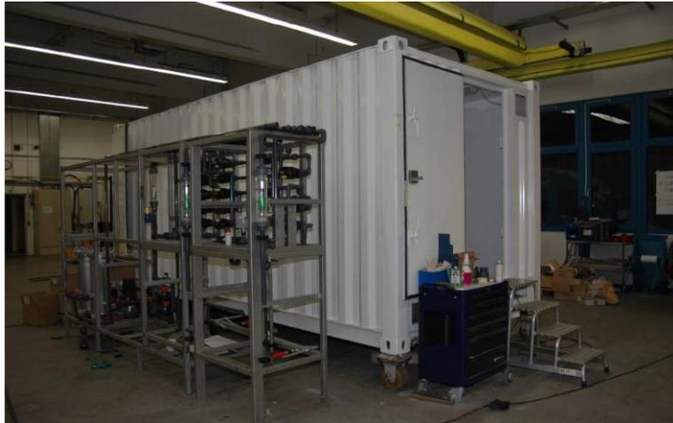
**Figura 3-72:** Container metálico do sistema de Osmose Reversa.
