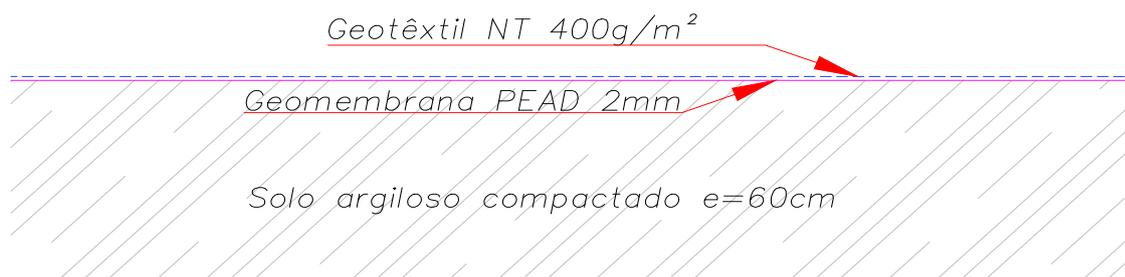
**Figura 3-30:** Esquema conceitual do sistema de impermeabilização de base e de taludes
