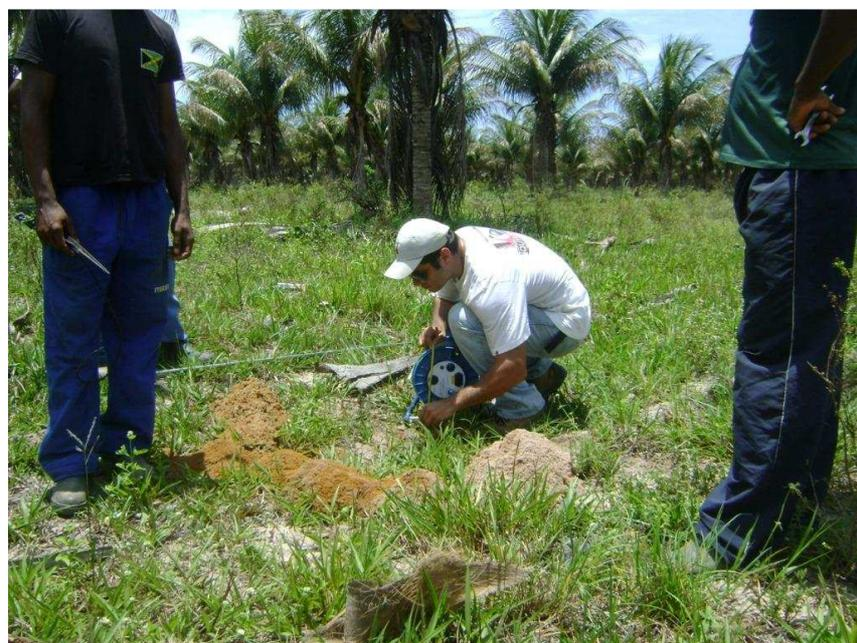
Foto 14 - Detalhe para medição do nível de água
