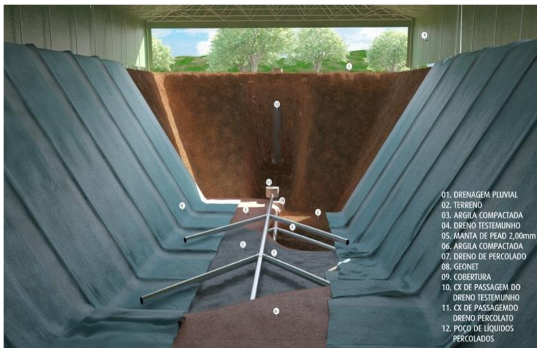
Figura 6.2-2 – Detalhe das camadas de impermeabilização e drenagem
