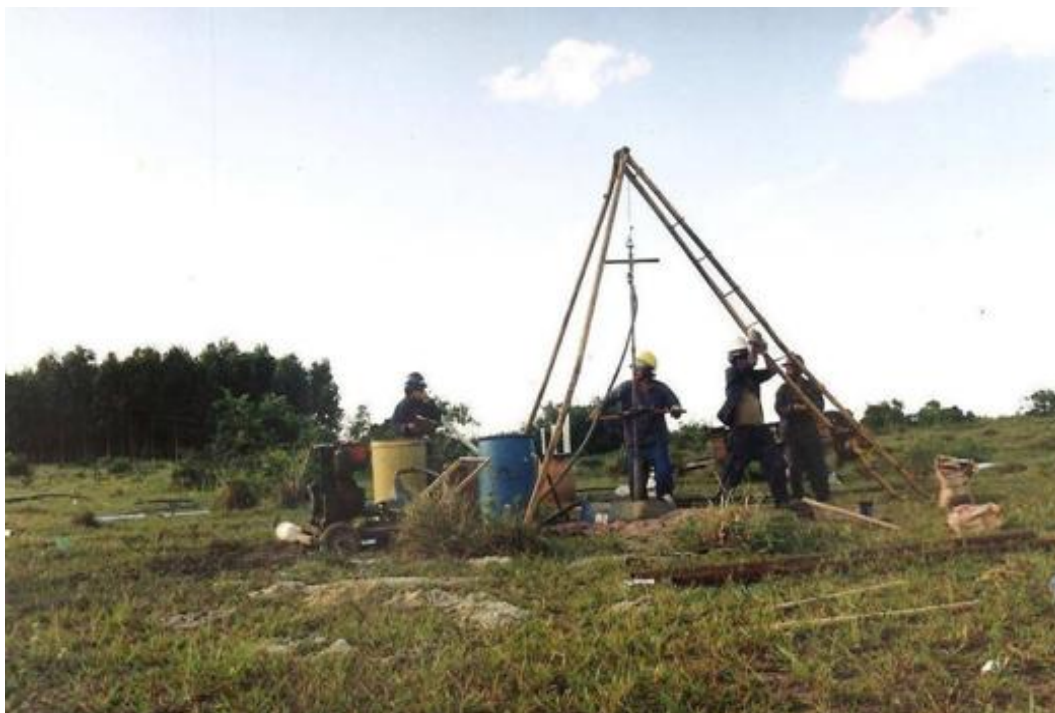
Figura 8.1-13 - Realização dos trabalhos de sondagem SPT – momento da lavagem do furo
