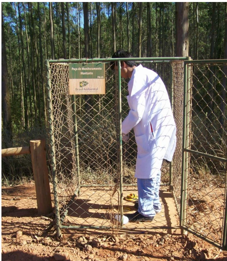
Figura 6.4-5 – Exemplo de poço de monitoramento de água subterrânea.
