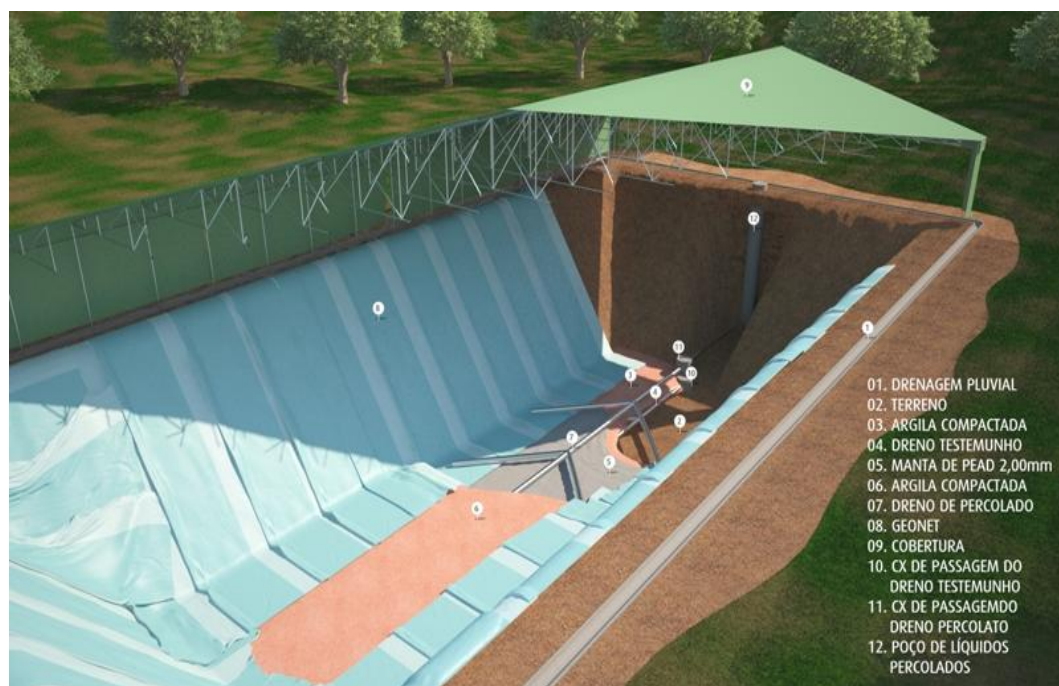
Figura 6.2-1 - Detalhe típico de valas classe I
