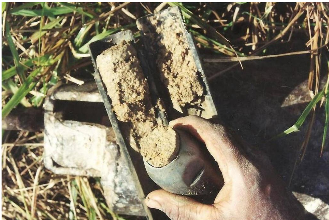
Figura 8.1-15 - Realização dos trabalhos de sondagem SPT – amostra de argila muito arenosa amarela dentro do amostrador
