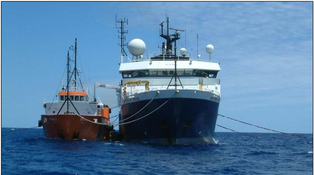
**Figura II.2.1.5-1 – Vista do processo de abastecimento do navio sísmico em mar aberto .**
