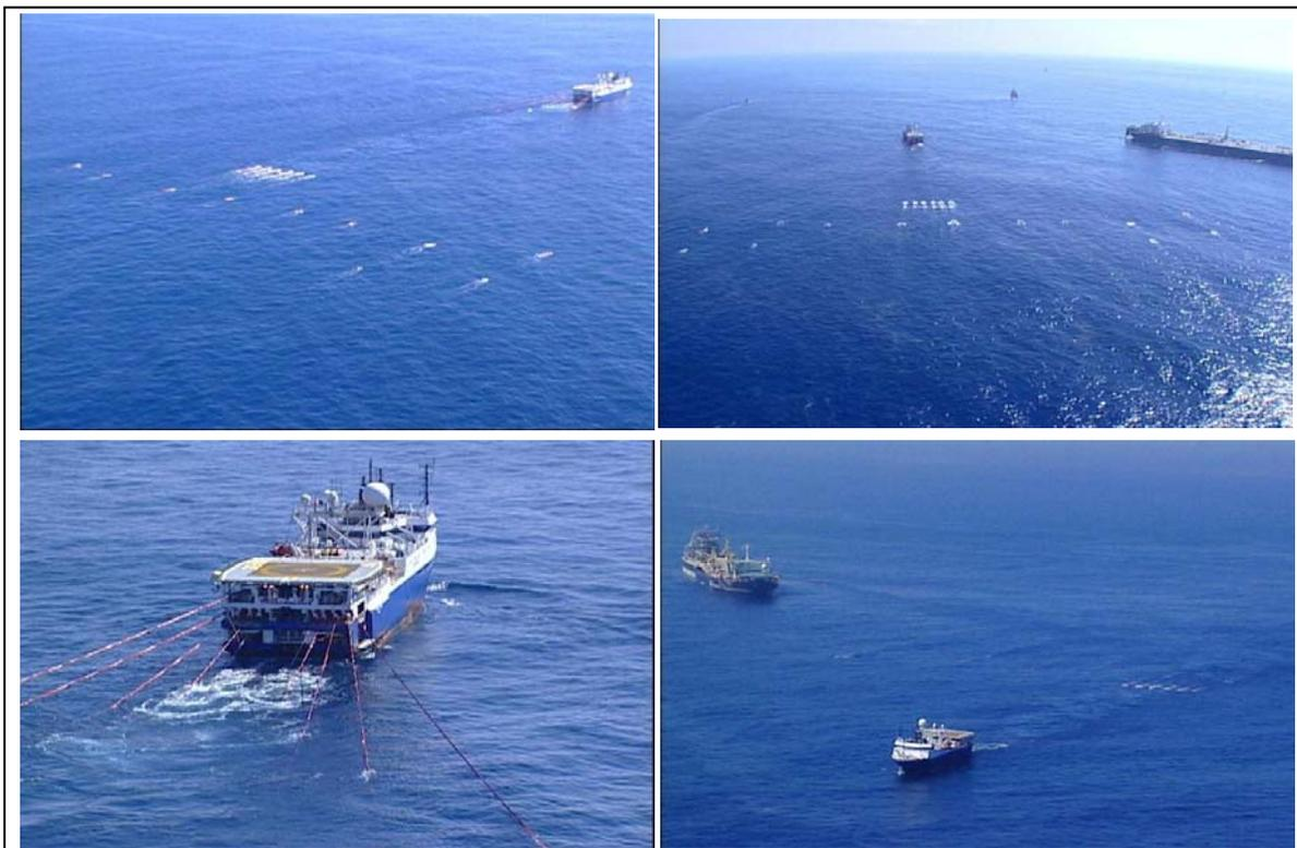
**Figura II.2.3-2** - Fotos aéreas ilustrando um arranjo sísmico rebocado durante uma operação de aquisição de dados (Fonte: Petrobras)
