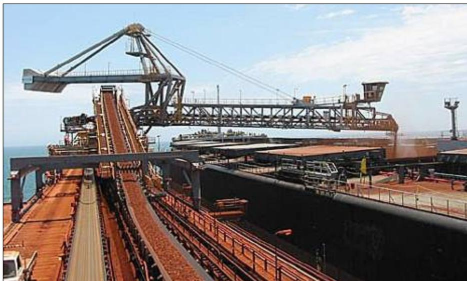
Figura 2.4.2.4-3: Carregador de navios do tipo travelling.
