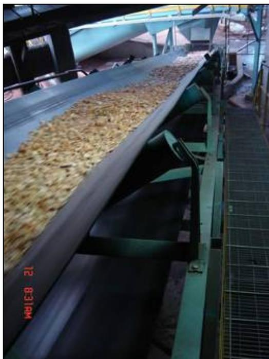
Figura 2.4.2.2-3: Exemplo de transportador de correia (obtido no site <http://www.apequipamentos.com.br/e1.htm>).
