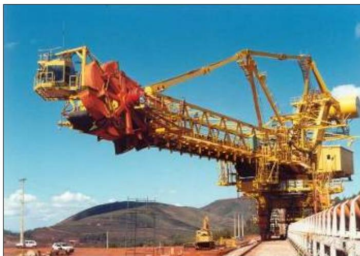
Figura 2.4.2.3-7: Retomadora de lança com roda de caçambas.
