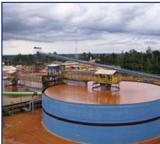
Figura 2.4.2.2-4: Exemplo de Espessador de processo (obtido no site <http://brasil.infomine.com/suppliers/listings/33815.asp>).
