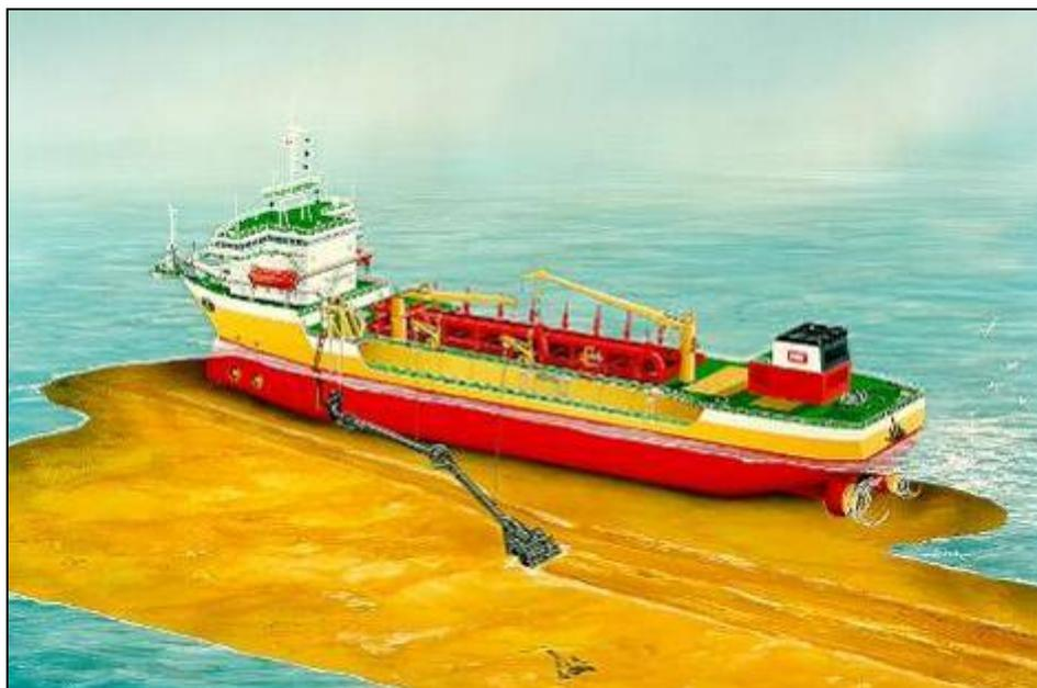
Figura 2.4.4.1-2: Desenho esquemático de uma draga Hopper operando.
