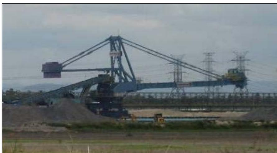
Figura 2.4.2.3-8: Empilhadeira/retomadora de lança com roda de caçambas.
