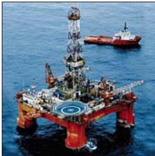
Figura II.3-2 - Plataforma de perfuração semissubmersível *SOVEREIGN EXPLORER* (SOVEX)
