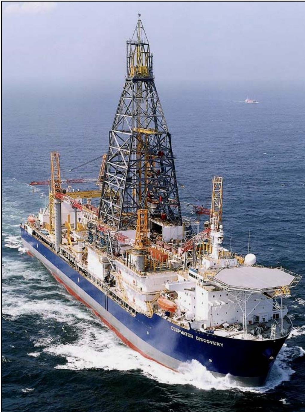
Figura II.3-3 - Plataforma de perfuração navio-sonda *Deepwater Discovery*
