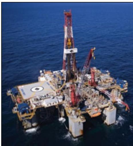
Figura II.7-1 - Exemplo de plataforma semissubmersível
