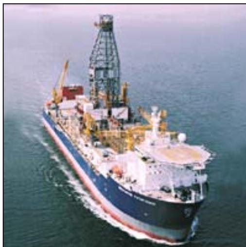
Figura II.7-2 - Exemplo de plataforma navio-sonda
