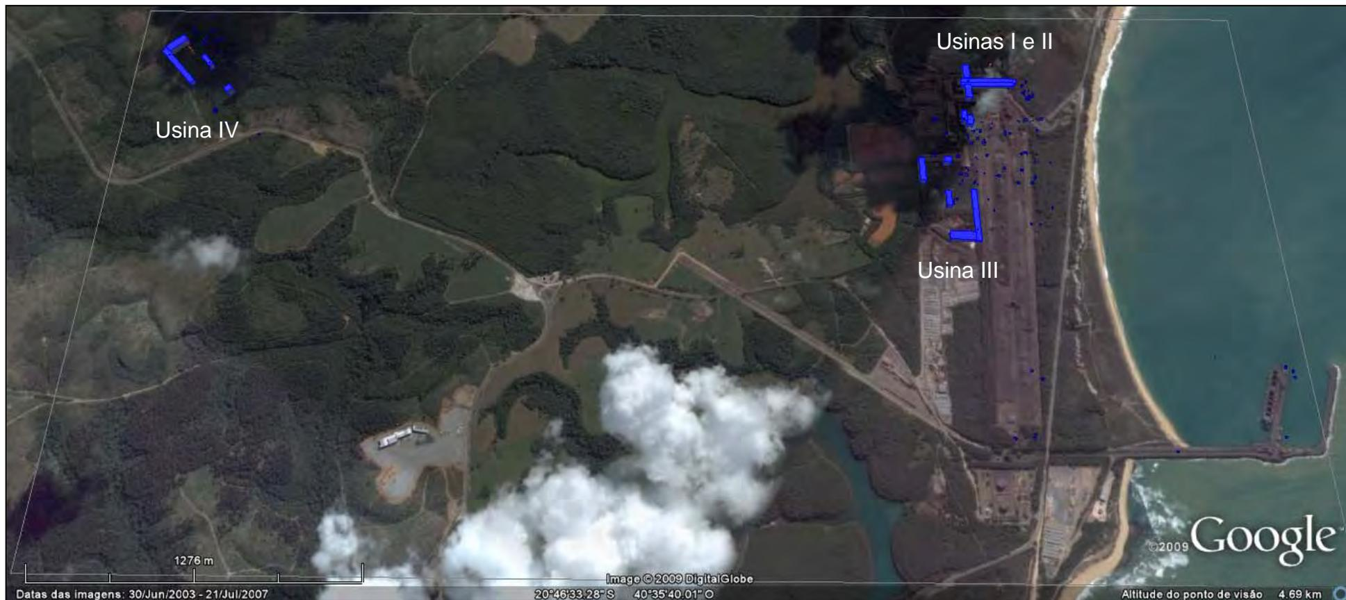
**Figura 1.11.2.2-1: Localização das chaminés e dos prédios de altura significativa que irão influenciar na dispersão de poluentes da Samarco Mineração gerada pelo AERMOD. Os pontos em vermelho são as fontes pontuais (chaminés); os pontos em azul são as fontes do tipo volume, e os retângulos em azul são as edificações consideradas.**
