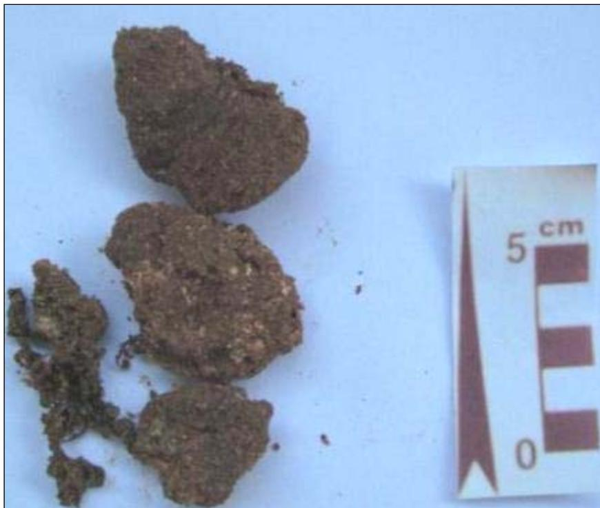
**Figura 5-243:** Amostra de alga calcária com areia fina retirada no ponto “JP 22”.
