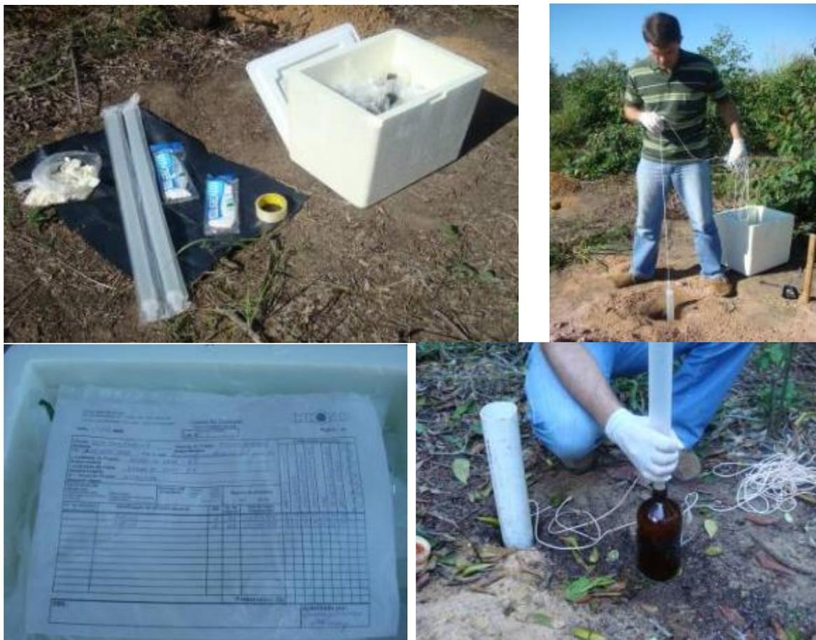
**Figura 5-201:** Imagens da coleta de águas subterrâneas nos furos de sondagem na área de estudo e da caixa de isopor com a cadeia de custódia para despacho ao laboratório.
