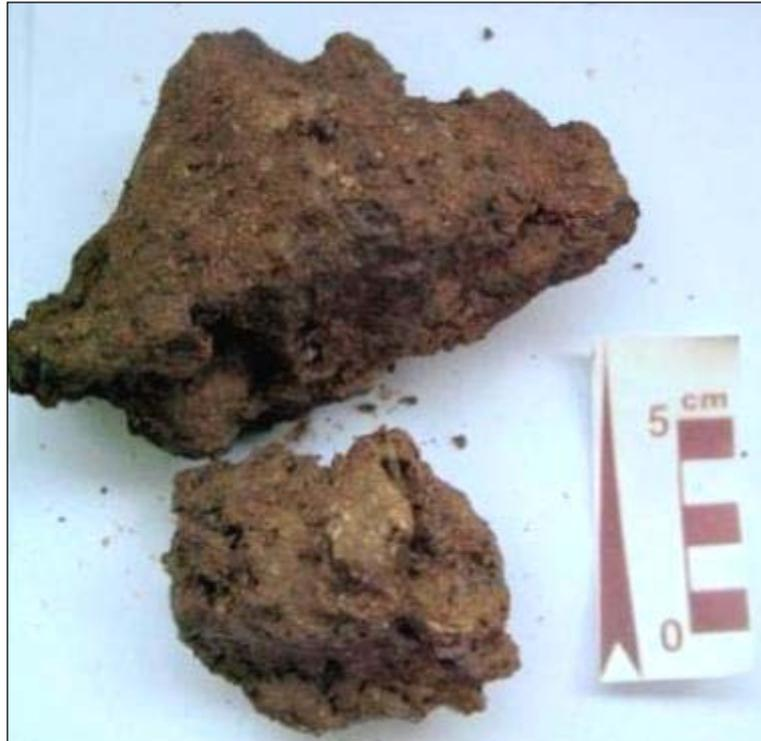
**Figura 5-264:** Amostra de laterita retirada no ponto “JP 44”.
