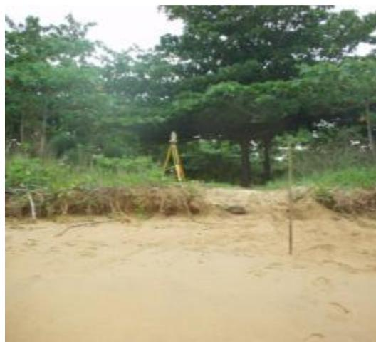
**Figura 5-67:** Linha de marcos de apoio ao levantamento dos perfis.
