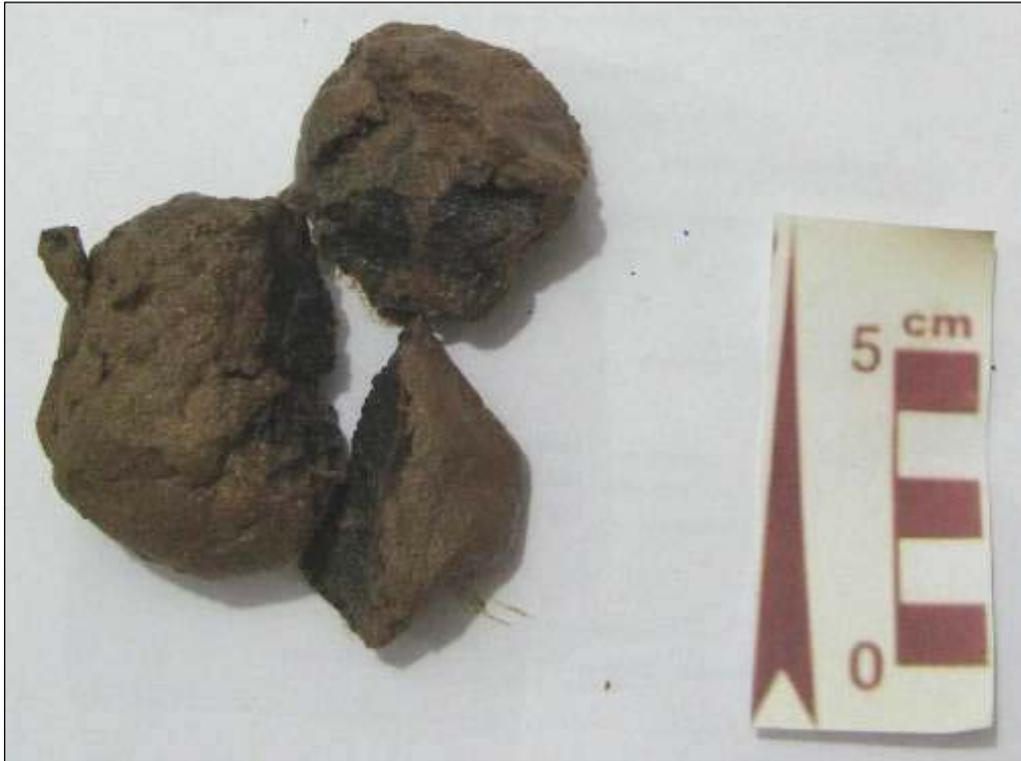
**Figura 5-262:** Amostra de argila com areia fina retirada no ponto “JP 41”.
