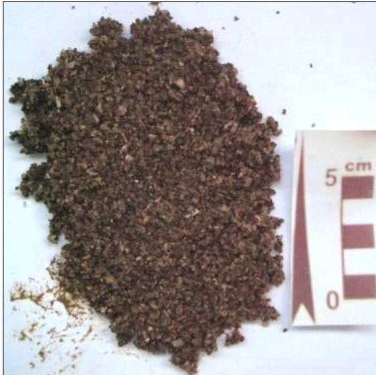
**Figura 5-251:** Amostra de areia grossa retirada no ponto “JP 30”.
