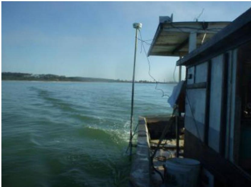
**Figura 5-23:** ADCP e antena do sistema de posicionamento DGPS na embarcação.
