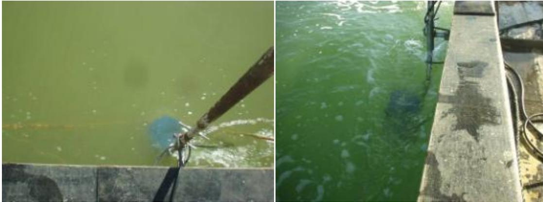
**Figura 5-22:** ADCP instalado na lateral da embarcação. Vistas superior e lateral.
