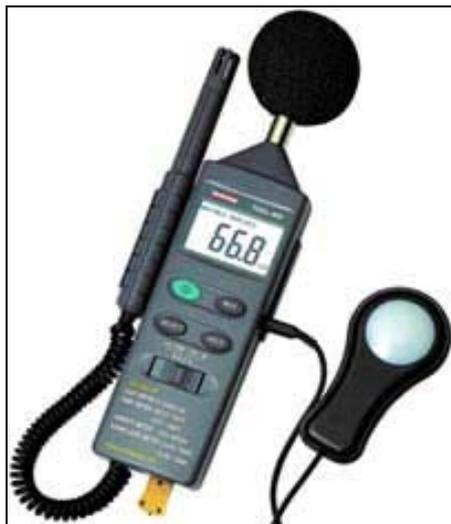
**Figura 5-326:** Medidor INSTRUTHERM, modelo THDL-400, utilizado nas medições de níveis de ruído.
