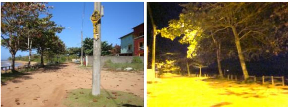
**Figura 5-373:** Sistema de iluminação de Barra do Sahy, em zona periurbana mais densa, composto por luminária fechada com refrator prismático e lâmpada de vapor de sódio de alta pressão.
