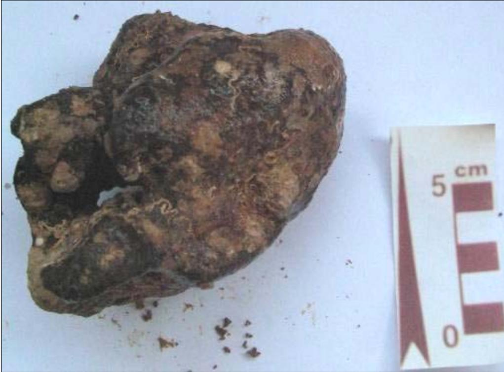
**Figura 5-230:** Amostra de laterita retirada no ponto “JP 09”.
