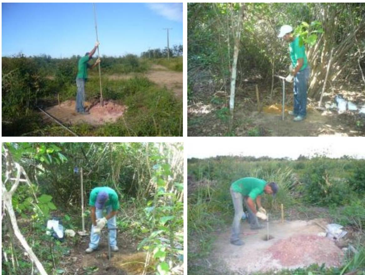
**Figura 5-192:** Imagens mostrando as operações de perfuração com trado manual.
