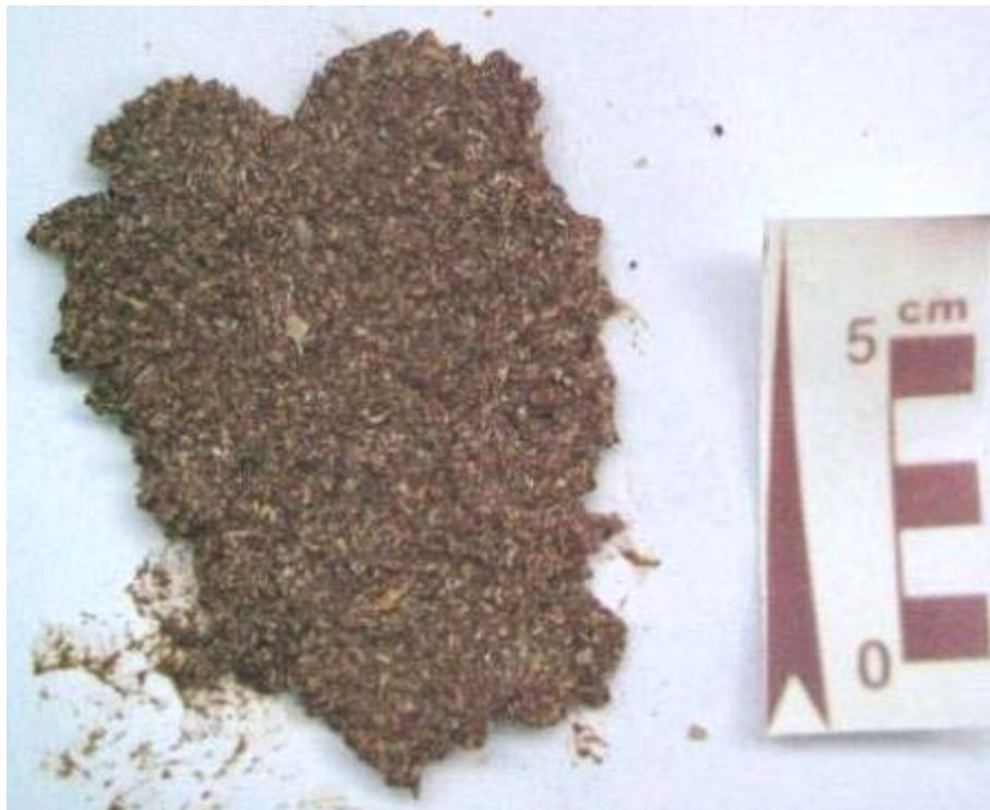
**Figura 5-225:** Amostra de areia média retirada no ponto “JP 04”.
