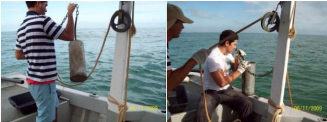
Figura 5- 154: Lançamento e içamento do amostrador.
