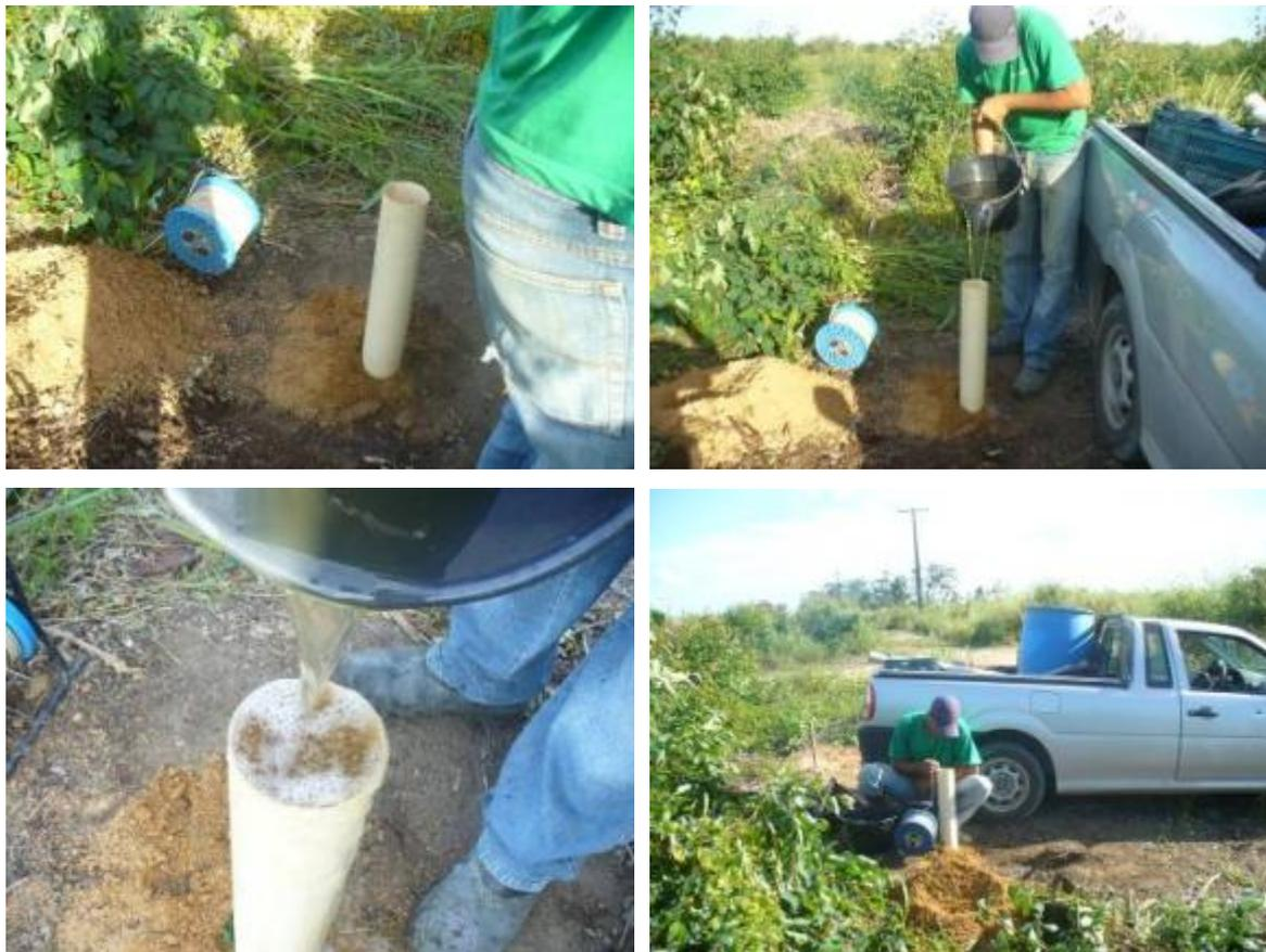
**Figura 5-195:** Imagens que ilustram os testes de permeabilidade realizados em dos furos de sondagens na área de estudo.
