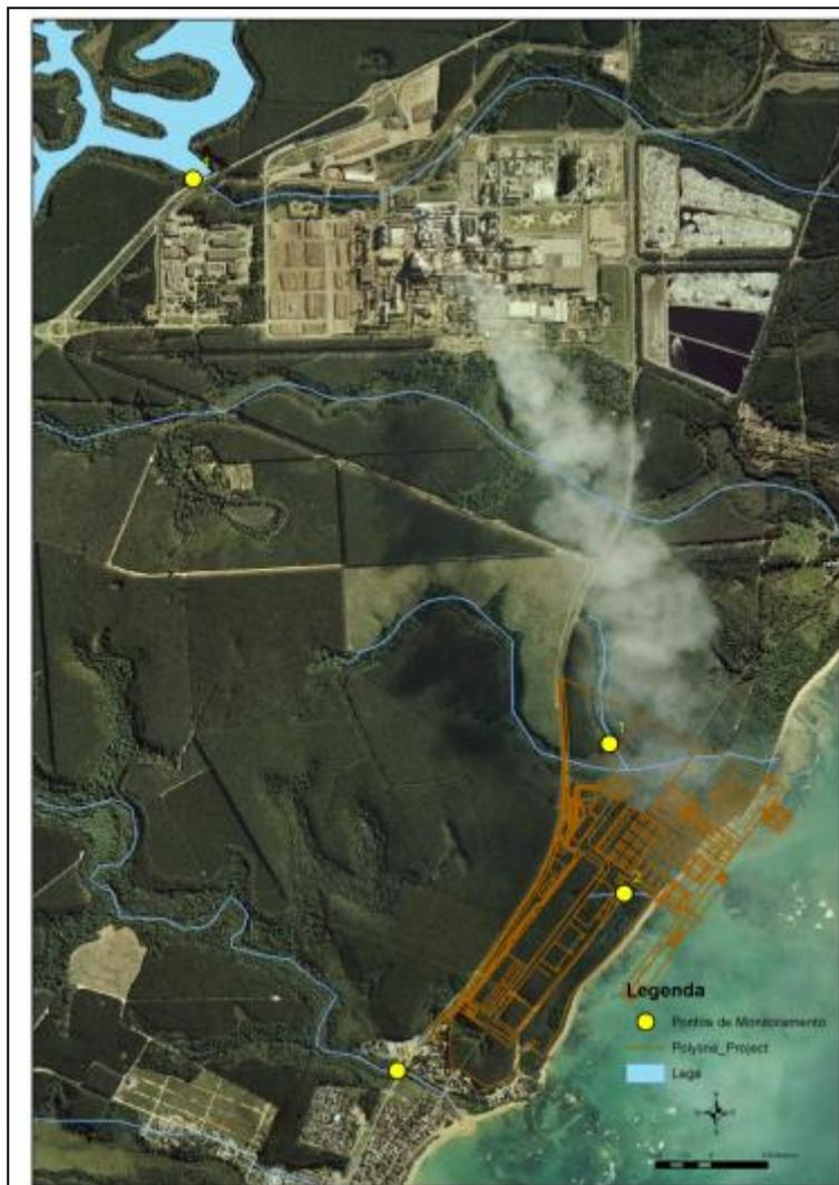
**Figura 5-188:** Pontos de monitoramento da qualidade de águas superficiais.
