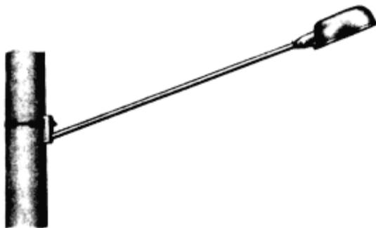
**Figura 5-365:** Luminária instalada em braço com inclinação vertical elevada.
