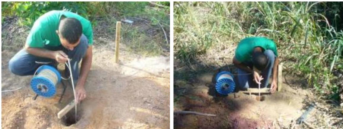
**Figura 5-196:** Imagens que ilustram as medições dos níveis de água nos furos de sondagem.
