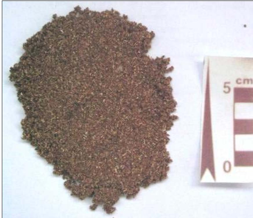
**Figura 5-224:** Amostra de areia média retirada no ponto “JP 03”.
