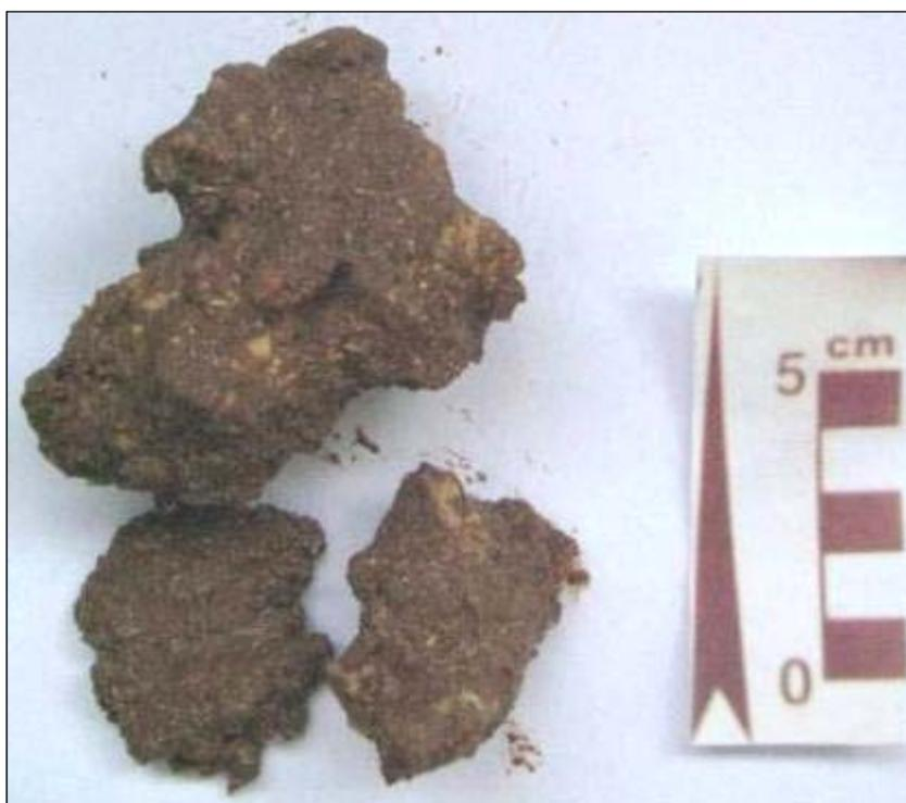
**Figura 5-223:** Amostra de areia fina com alga calcária retirada no ponto “JP 02”.
