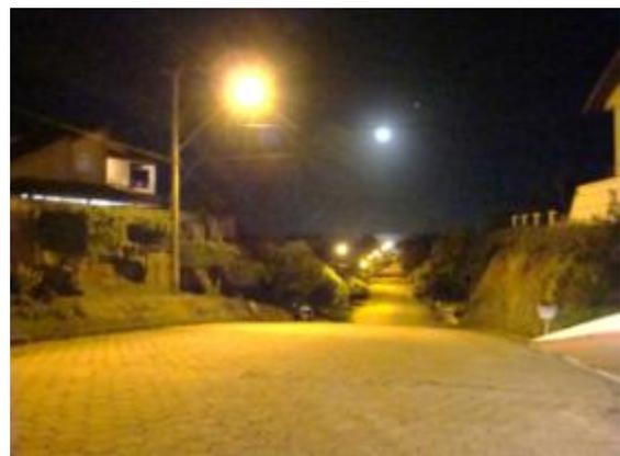
**Figura 5-370:** Sistema de iluminação de Mar Azul, zona periurbana, composto por luminária fechada com refrator prismático e lâmpada de vapor de sódio de alta pressão.
