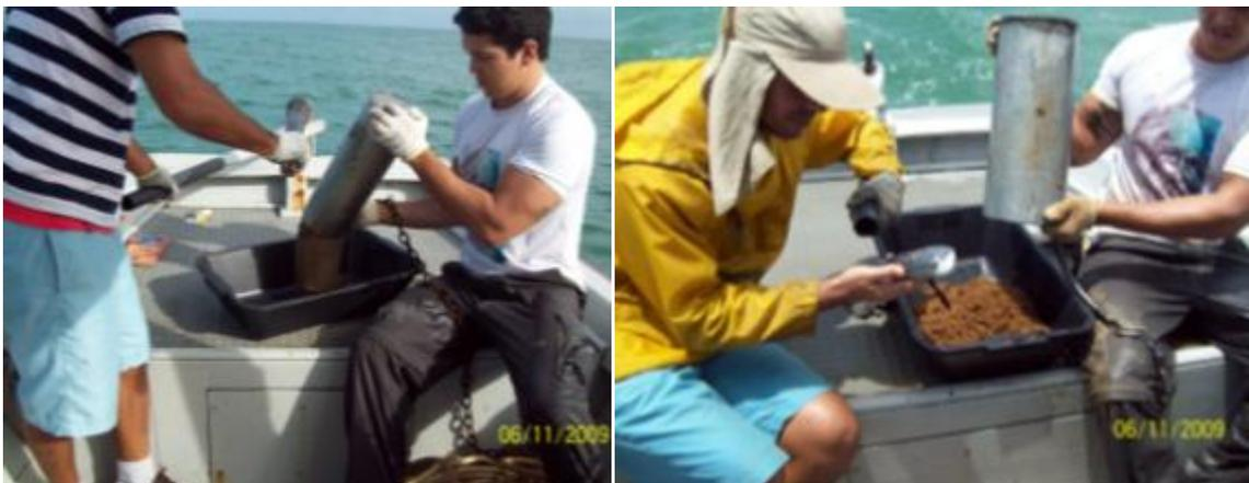
Figura 5- 155: Amostra sendo retirada do amostrador.
