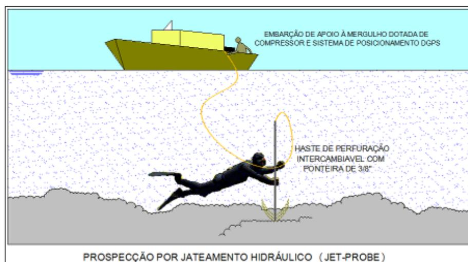
**Figura 5-220:** Sistema de prospecção por Jateamento Hidráulico
