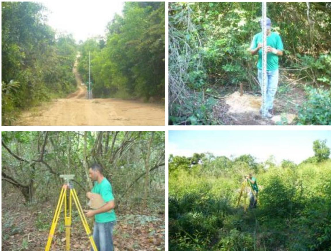
**Figura 5-197:** Imagens do levantamento altimétrico na área de estudo.
