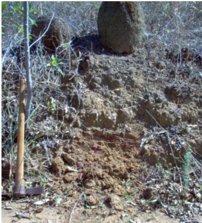
**Figura 5-290:** Perfil do Plintossolo Pétrico que ocorre ao norte da AID.
