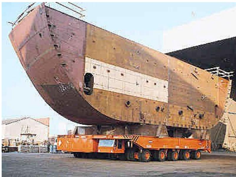
**Figura 2-36:** Foto do Kamag transportando um bloco.
