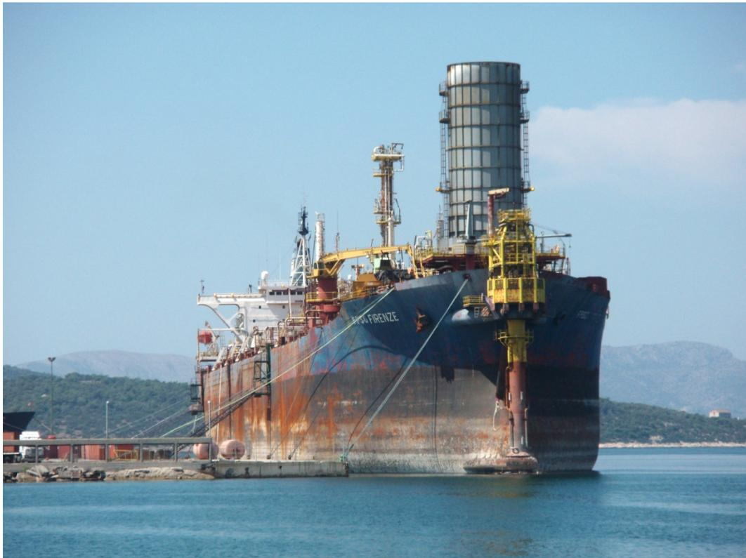
**Figura 2-13:** Ilustração de uma unidade FPSO - *Floating Production Storage Offloading*.
