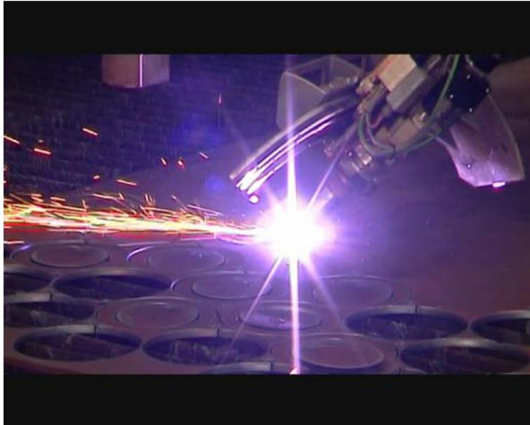
**Figura 2-45:** Operação de corte a plasma em chapa metálica.
