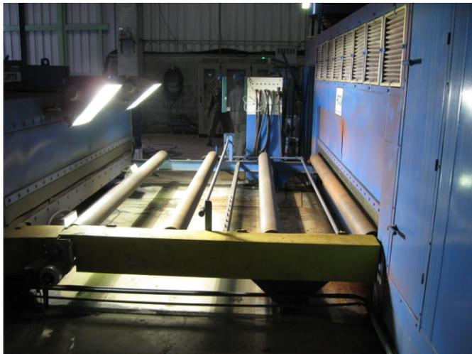
**Figura 2-31:** Máquina de aplicação do *primer*.
