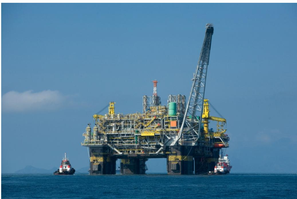
**Figura 2-12:** Plataforma semisubmersível.
