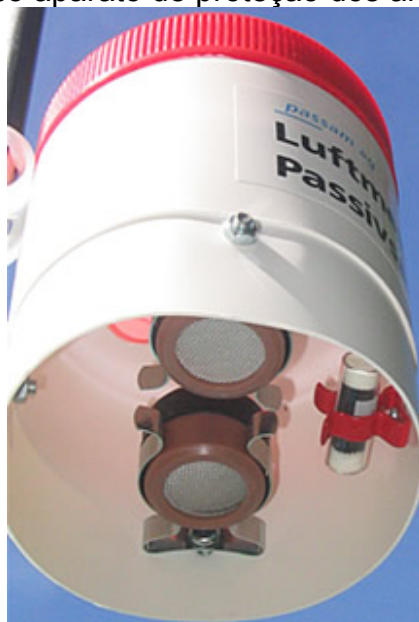
Figura 4.2-11 – Típico aparato de proteção dos amostradores passivos.
