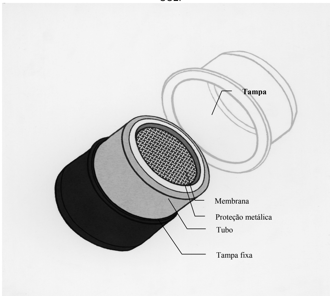
Figura 4.2-12 – Representação esquemática de um amostrador passivo de SO 2 .
