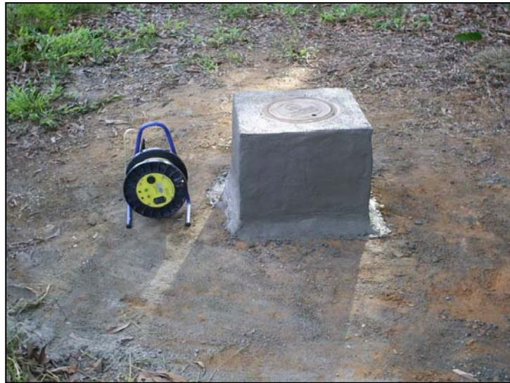
Figura 9.2-1: Poço de monitoramento com medidor de nível de água.
