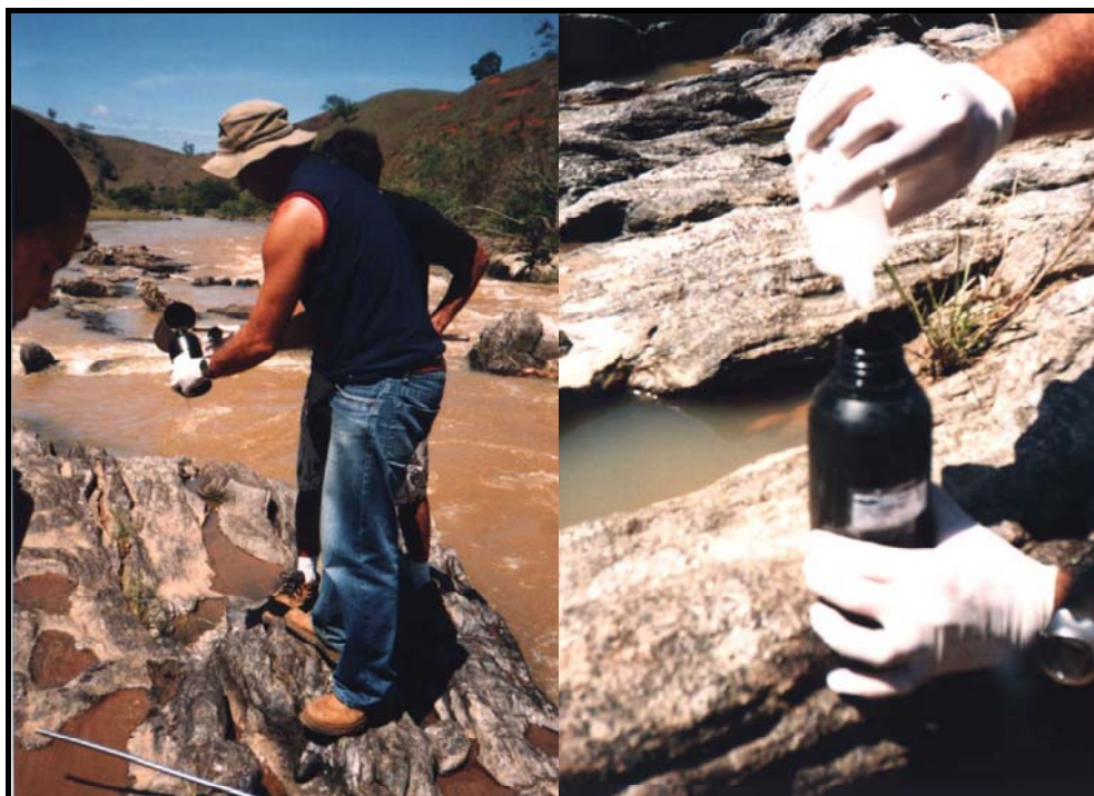
Figura 4.1.4.16 - Coleta de água no ponto de amostragem MAS 02, PCH Santa Fé Barragem de Geração – N 7.709.448 E 238. 162 DATUM SAD 69 MC 29°.
