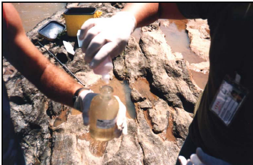
Figura 4.1.4.18 – Conservação das amostras de água superficial para análise laboratorial.
