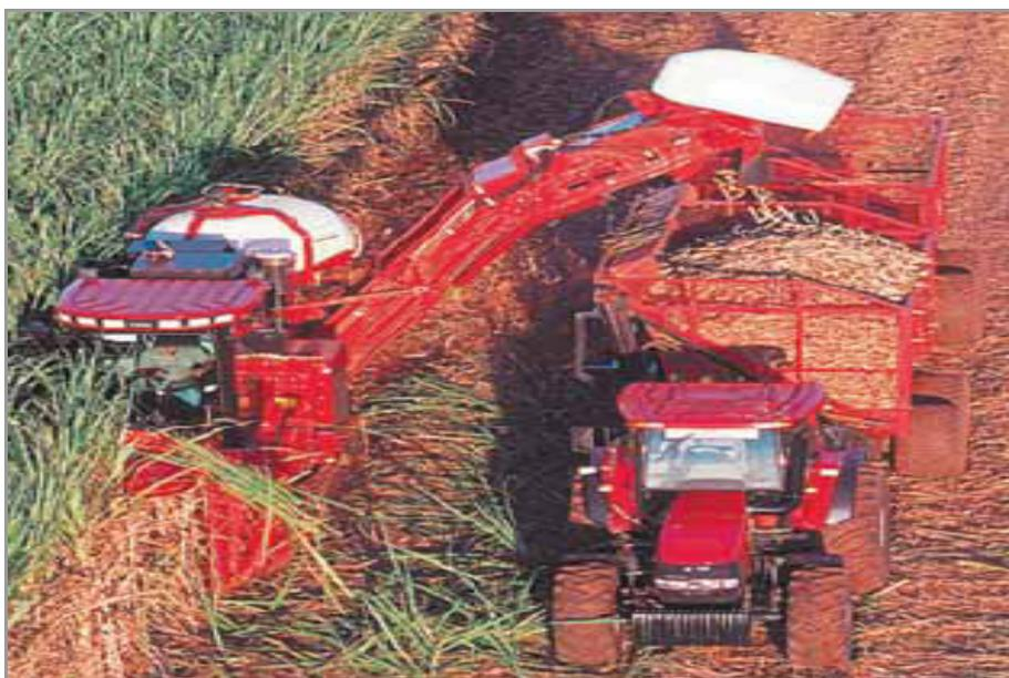
**Figura 6.1.2.1.1-16 – Ilustração de processo de corte da cana mecanizado**
