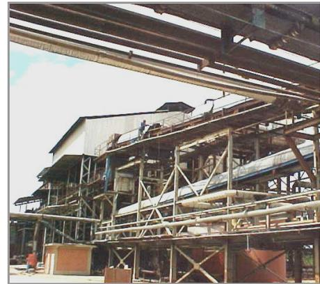
**Figura 6.1.2.1.1-12 – Fotos ilustrativas de correias transportadoras de bagaço de cana devidamente enclausurada com proteção em forma de “U” e suas laterais fechadas.**
