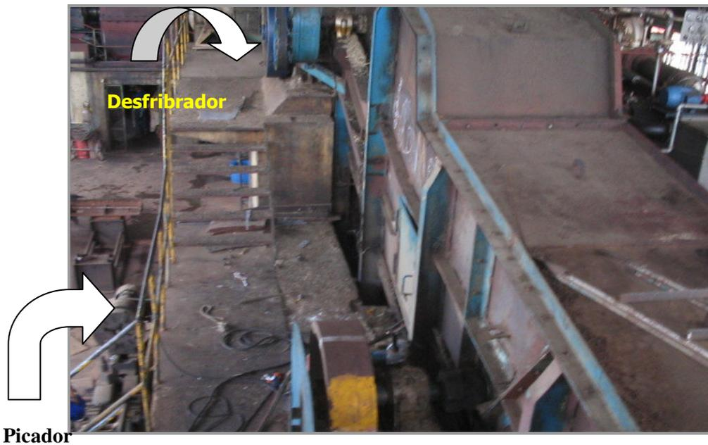
**Figura 4.6.2.1-6 – Detalhe do picador/desfriador**
