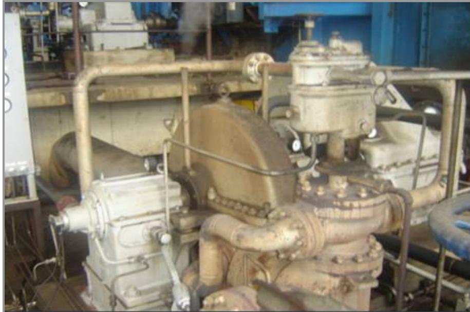
**Figura 6.1.2.1.1-10 – Foto ilustrativa de equipamento que se utiliza do vapor para gerar energia mecânica e processar a trituração da cana-de-açúcar**
