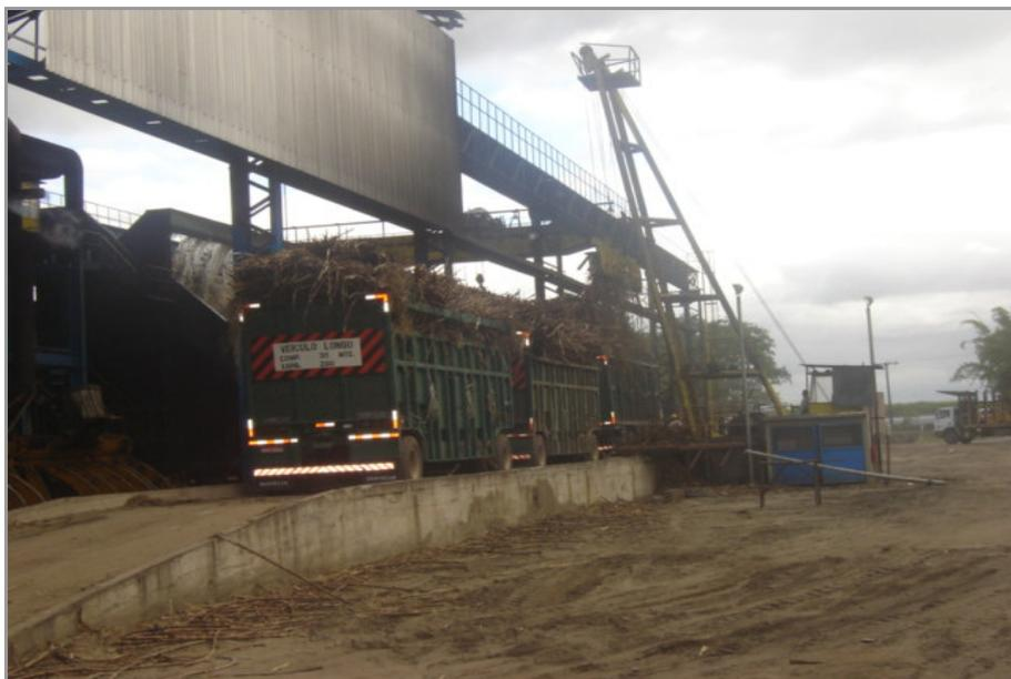
**Figura 6.1.2.1.1-8 – Foto ilustrativa dos caminhões transportadores de cana-de-açúcar (volume), no momento do descarregamento pelo guincho tombadores (hillos)**
