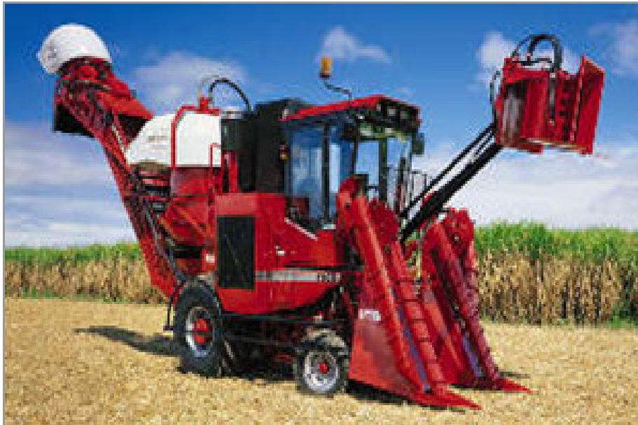
**Figura 6.1.2.1.1-14 – Ilustração colhedeira CASE modelo 7000, potência de 335 CV (246 KW), tipo de rodado pneus e altura do despontador 3600 mm**
