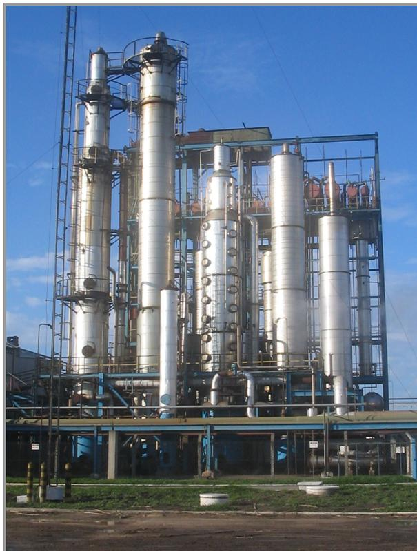
**Figura 4.6.1.1-10 – Colunas de destilação**
