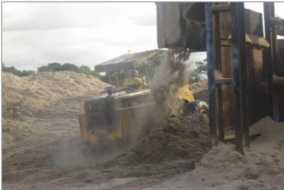
**Figura 6.1.2.1.1-1.9 – Foto ilustrativa mostrando equipamento (pá carregadeira), em atividade de armazenamento do excesso bagaço de cana-de-açúcar e que será utilizado na caldeira como combustível**
