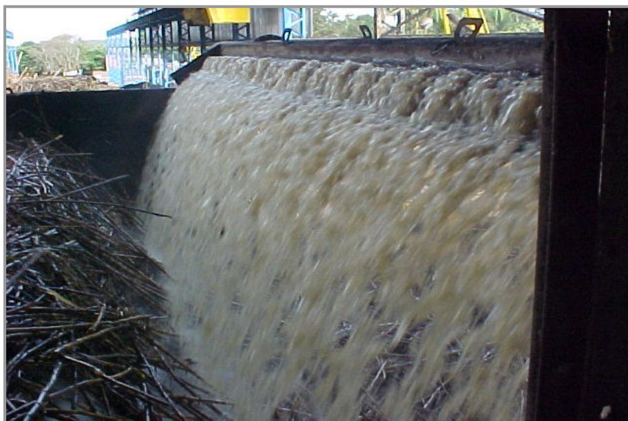
**Figura 4.6.2.1-4 – Vista geral do sistema de lavagem da cana-de-açúcar**
