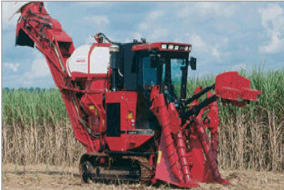
**Figura 6.1.2.1.1-15 – Ilustração colhedeira CASE modelo 7700, potência de 335 CV (246 KW), tipo de rodado esteira e altura do despontador 3600 mm**
