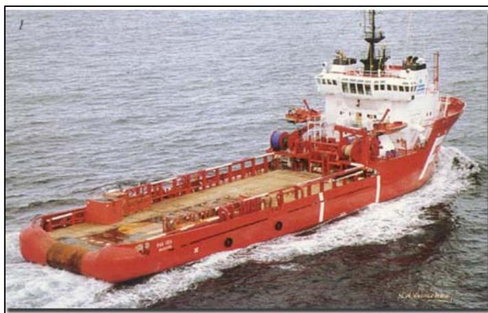
*Figura II.8.5.2.1-6 - Embarcação tipo AHTS para movimentação das âncoras da BGL-1*
