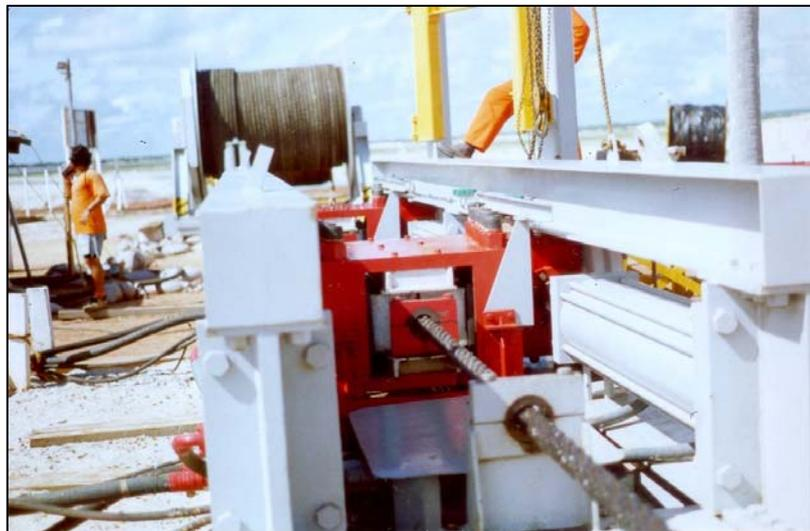
**Figura II.8.5.2.1-1** - Equipamento CPM 600 responsável pelo arraste do gasoduto para a praia de Cacimbas
