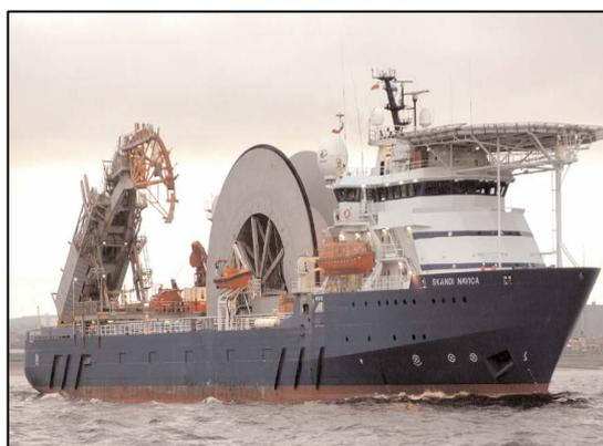
**Figura II.8.5.2.1-9** - Embarcação Skandi Navica a ser utilizada para lançamento em águas profundas
