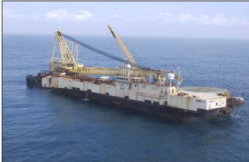
**Figura II.8.5.2.1-3 - Balsa Guindaste de Lançamento - gasoduto em águas rasas**
