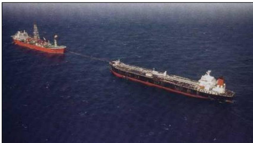
**Figura II.8.3.3-8-** Vista aérea da operação de *offloading* de um FPSO para um navio aliviador
