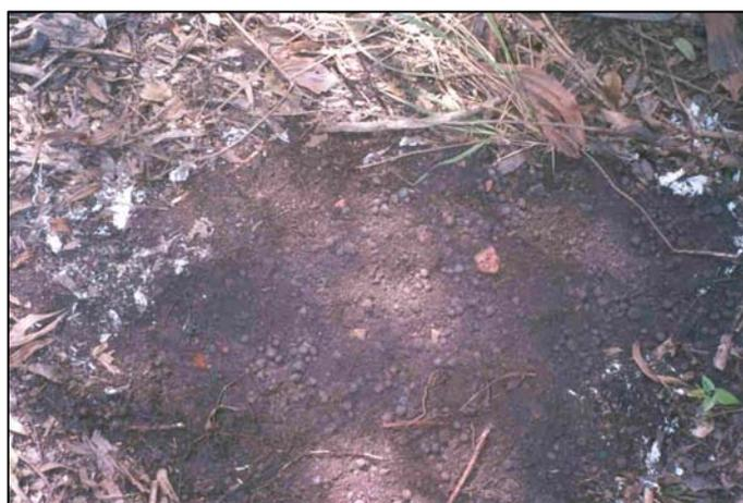
**Figura 3.3.5.3-10: Solo com grossa capa de pelotas de ferro observado em sondagem realizada em mata de eucalipto.**
