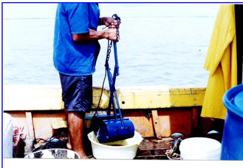
Foto 5.2.4 – Draga de Pettersen usada para coleta de sedimentos para análise de zoobentos marinho ao longo do oleoduto entre TNC e a monoboia de atracação.
