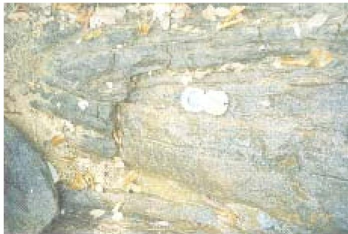
**Figura 18 - Detalhe do afloramento existente no local da casa de força do aproveitamento de Pirapetinga – Nota-se dobras apertadas comuns nestas rochas – margem direita.**
