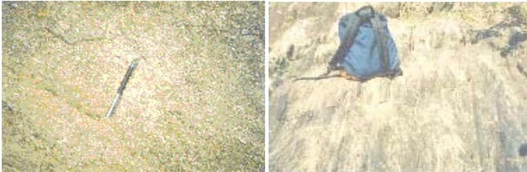
Detalhe do afloramento próximo ao local do emboque junto ao rio. Observa-se que os feldspatos estão mais desenvolvidos e sem orientação preferencial. Razão pela qual os afloramentos apresentam superfícies “mais arredondadas” - granito gnaissês.
