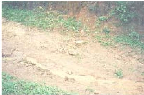
**Figura 7- Ombreira direita, sondagem realizada sobre a entrada, solo residual jovem.**
