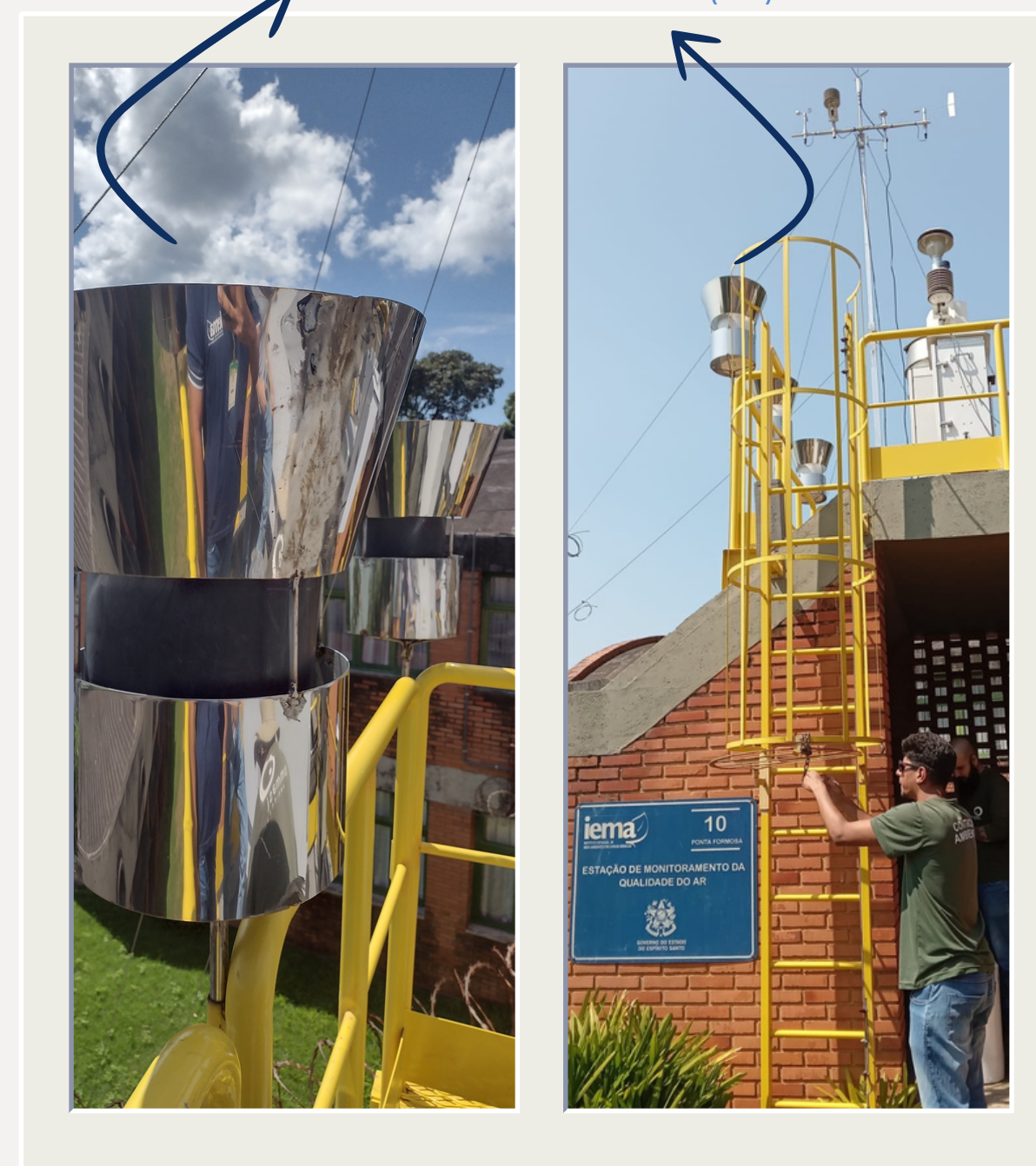
Recipiente coletor de Partícula Sedimentável (PS)
