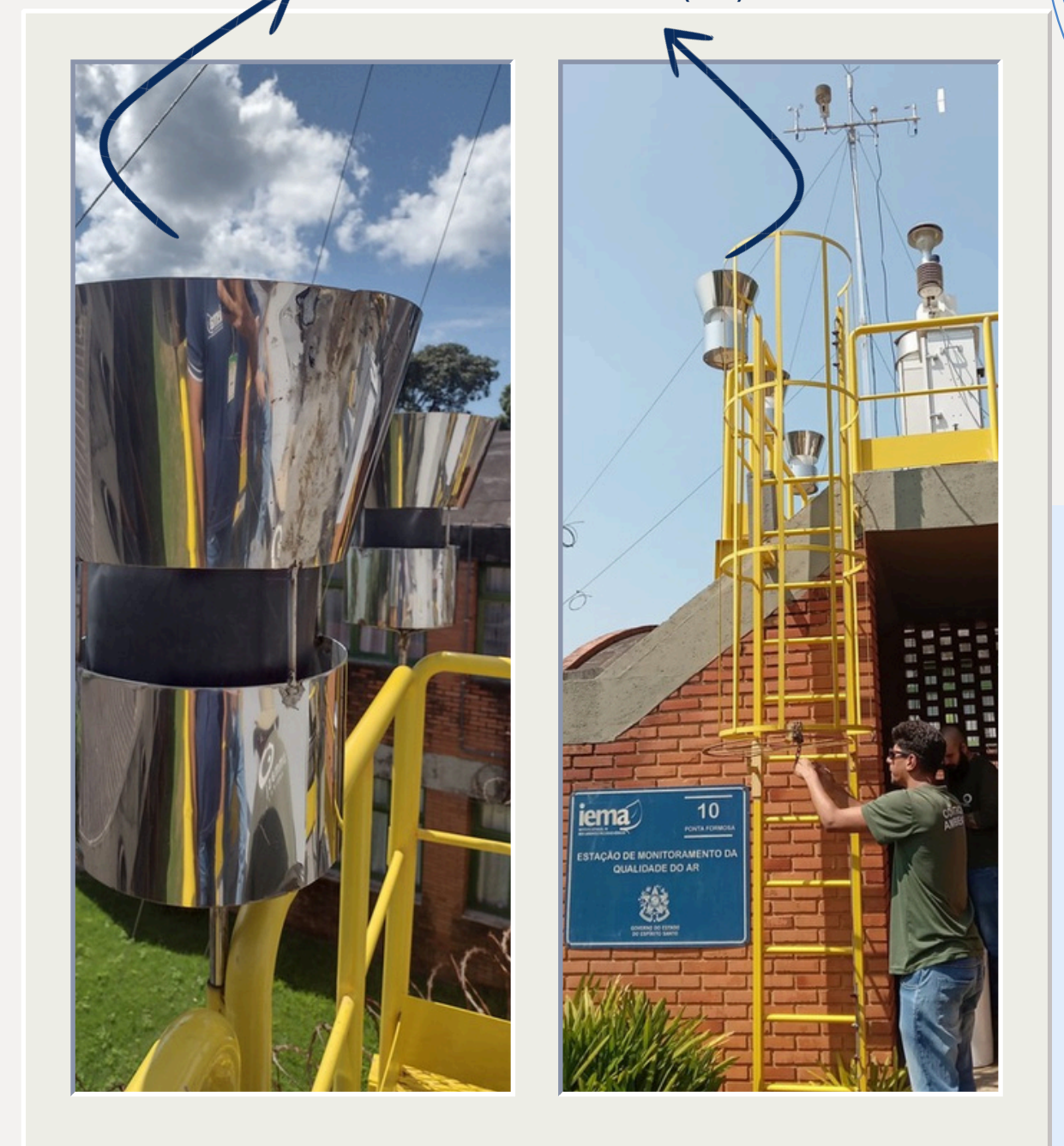
Recipiente coletor de Poeira Sedimentável (PS)
