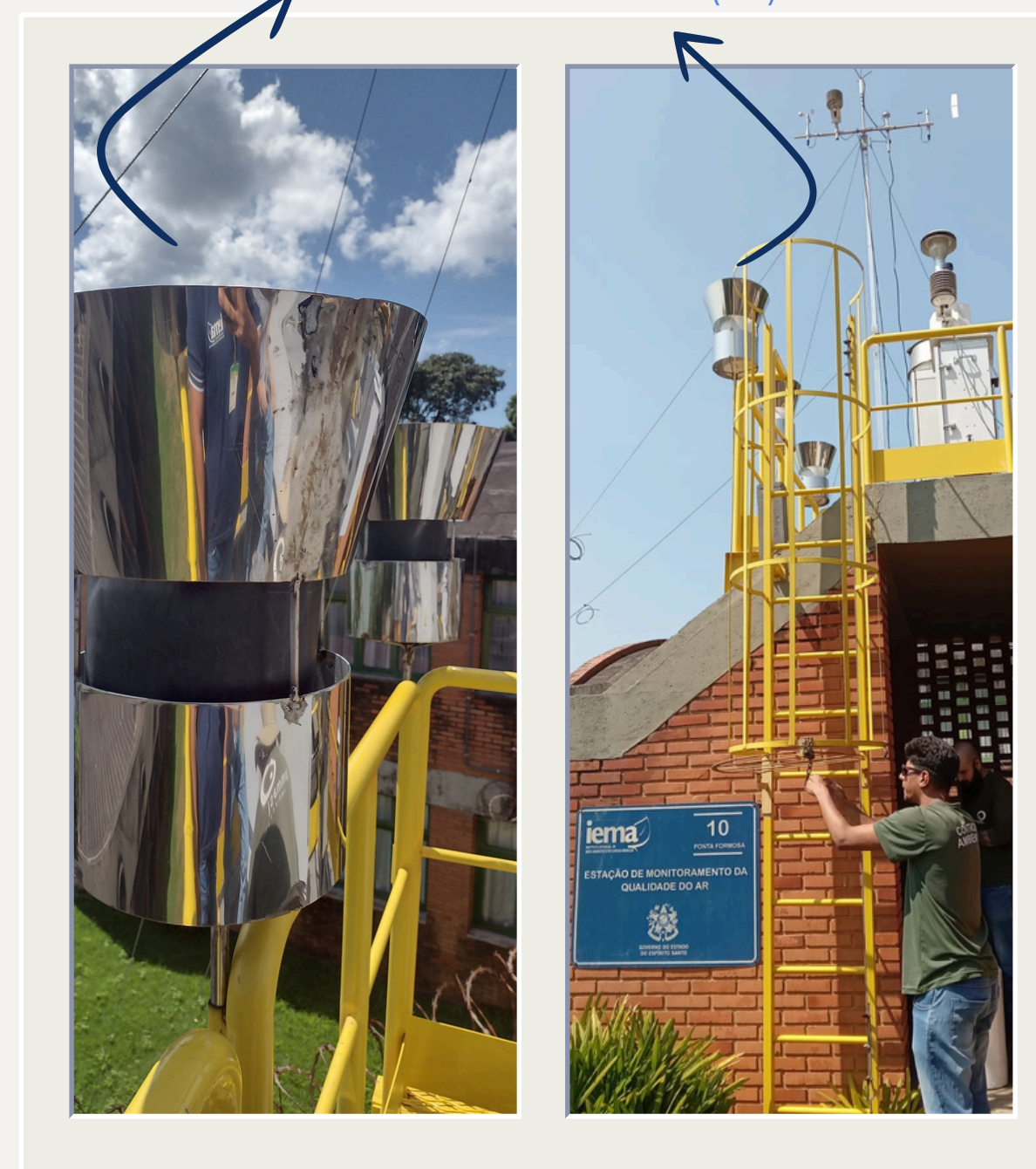
Recipiente coletor de Partícula Sedimentável (PS)
