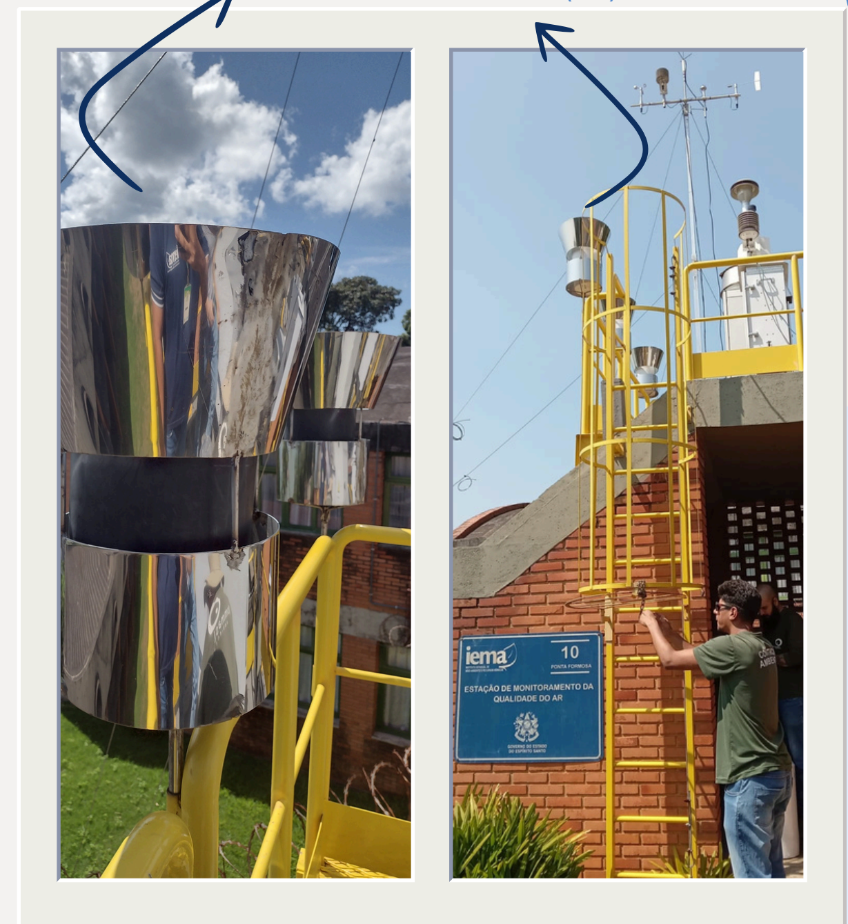
Recipiente coletor de Partícula Sedimentável (PS)
