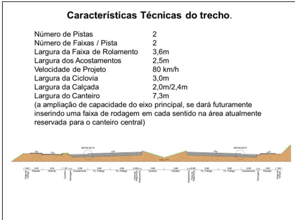
Isso aqui é uma seção típica da pista a ser implantada. Conforme disse são duas faixas em cada sentido, com acostamentos; o canteiro central com largura suficiente para no futuro se quer ser feito uma ampliação de capacidade da rodovia, sem ser necessário outras desapropriações ou coisas do tipo.
