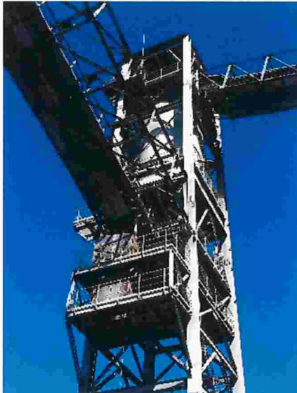
Figura 01 – As correias têm bandejamento e cobertura superior, mas não tem contenção lateral.
