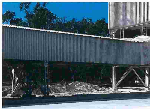
Figura 06 – Detalhe das correias transportadoras enclausuradas, mas com depósito de pós na cobertura e no piso.
