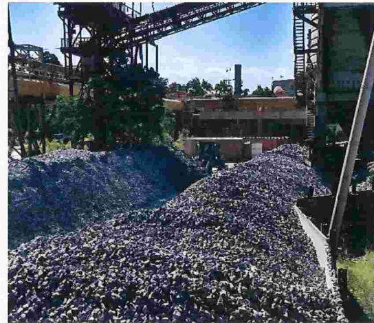
Figura 02 – Pátios com material sem identificação e delimitação física de pilhas, com movimentação por pá carregadeira
