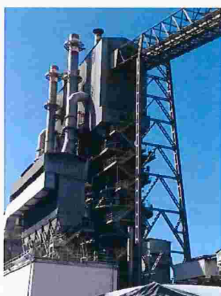
Figura 07 – Detalhe do forno de calcinação provido de filtro de mangas
